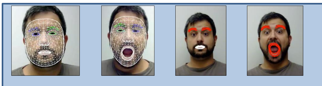
Figura 1. Sistema de reconocimiento del movimiento de cejas y boca, mediante el uso de visión computacional.
