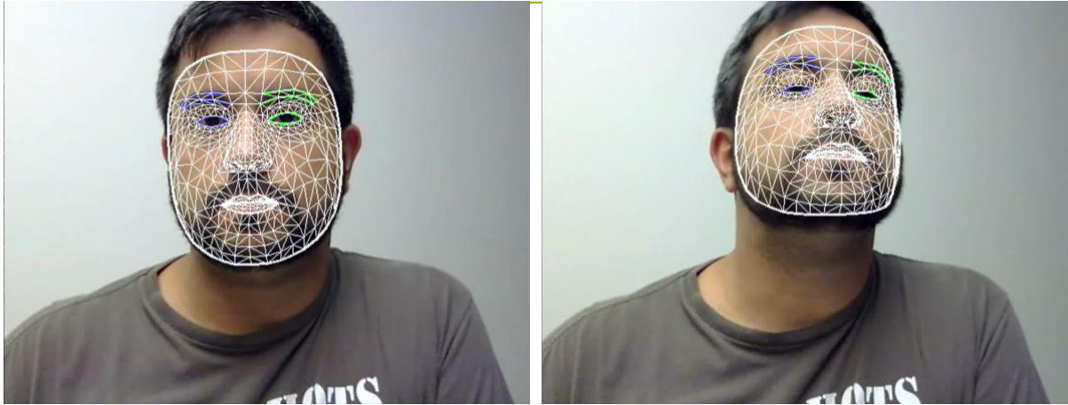
Figura 1. Ejemplos de detección de puntos de interés. A. Detección de puntos de interés en una cara frontal. Se destaca la ceja derecha en azul y la ceja izquierda en verde. B. Detección de puntos de interés en una cara rotada e inclinada.
