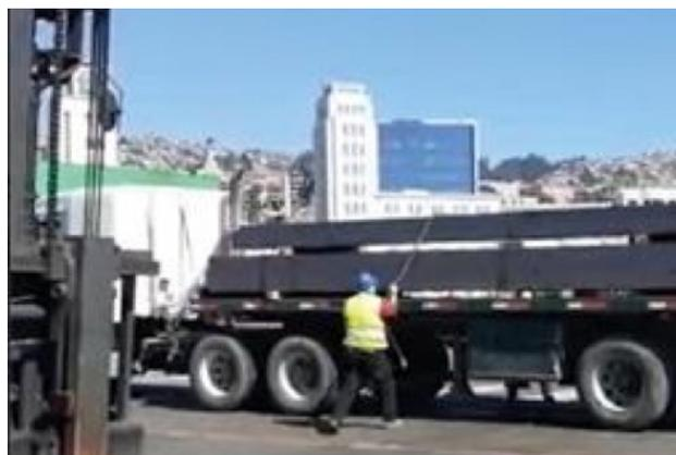
Una vez tensada la cadena manualmente, toma el gancho que tiene la cadena en su eslabón final y lo engancha en el camión. Enseguida, el movilizador procede a preparar el teclé de palanca (“la señorita”), para instalarlo en la cadena y terminar la trinca.
