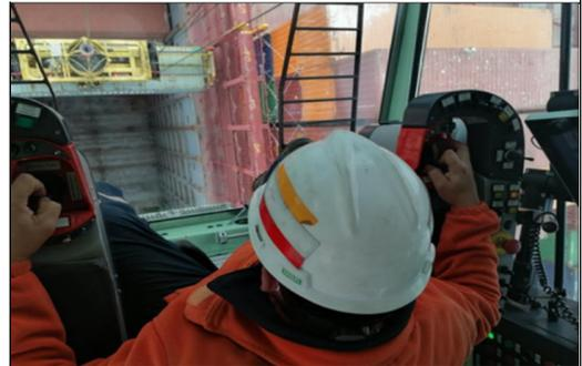
Se aprecia la visión que tiene el trabajador en la bodega del buque, mientras saca un contenedor. Se ve el spreader (amarillo), que toma el contenedor, lo iza y los traslada fuera de la nave. Se ven los comandos de la grúa.
