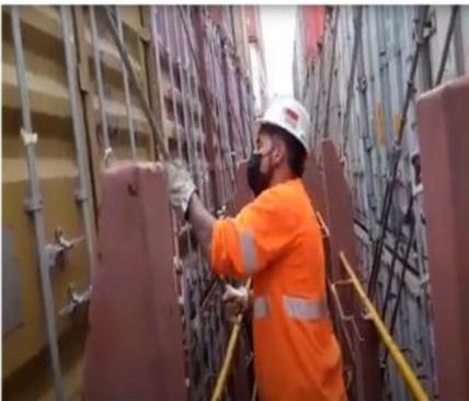
El trabajador verifica que la varilla metálica haya quedado bien sujeta a las esquinas del contenedor. Se aprecia supinación de ambos antebrazos, flexión de ambos codos y hombros, todas las posturas con uso de fuerza.
