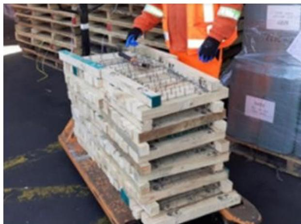
Por ejemplo, en el caso observado en terreno para la presente guía, los movilizadores tuvieron que colocar 7 trincas, es decir, martillaron 42 clavos para un contenedor con cobre.
