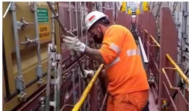
En la operación siguiente se realiza la trinca manual, que consiste en enroskar el tensor en la varilla. El trabajador enrosca ambas estructuras metálicas para que queden firmes.
