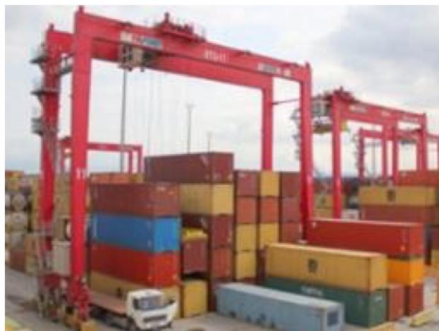
Esquema grúa Rubber Tyred Gantry (RTG)
