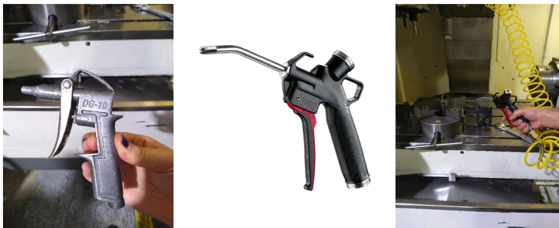
Figura 33. Pistola de aire comprimido convencional (izquierda), pistola de aire comprimido con tecnología de menor emisión de ruido (central) y uso de pistola en tareas de limpieza (derecha).
