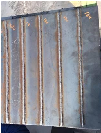
Figura 30. Cordones de soldadura efectuados en la empresa Indura.
