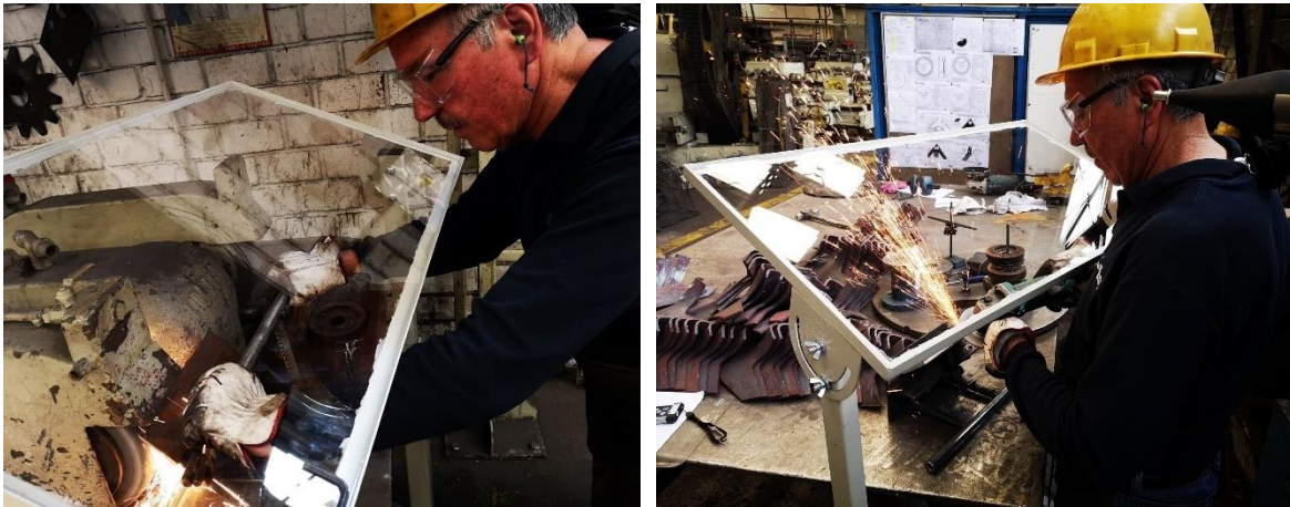
Figura 38. Utilización de pantalla acústica móvil en tareas de pulido con esmeril de pedestal (izquierda) y esmeril angular (derecha).
