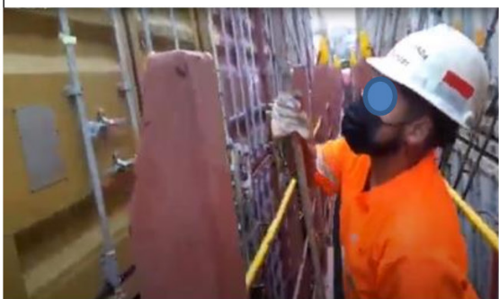
En esta fotografía se aprecia al trabajador de pie en un puente entre los contenedores dentro de la embarcación. Primero el trabajador alza la varilla metálica con el objetivo de engarcharla en una esquina o corner del contenedor. Para esto realiza flexión con fuerza de ambos hombros, con manos que llegan a la altura de su cabeza o sobre la altura de su cabeza. Se aprecia flexión de ambos codos, ambos antebrazos en supinación y agarre con fuerza.
