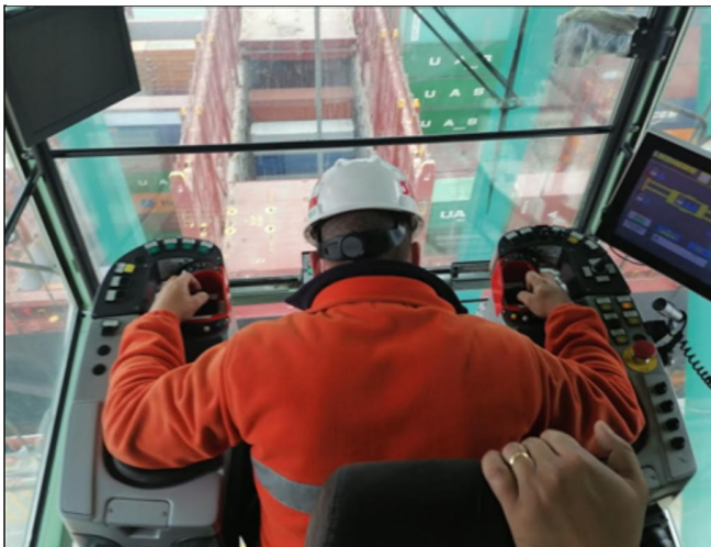
Se aprecia al trabajador inclinado hacia adelante, con flexión de segmento cervical y lumbar anterior. Al lado derecho es izquierdo se observan pantallas a las cuales debe atender ocasionalmente, que le indican datos la velocidad del viento, posición de la cabina en relación al suelo, altura del spreader, altura del contenedor, entre otros.
