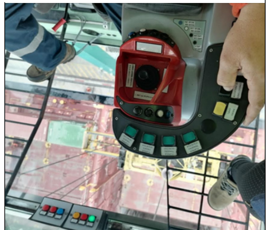
Se aprecia la visión que tiene el trabajador en la bodega del buque, mientras saca un contenedor. Se ve el spreader (amarillo), que toma el contenedor, lo iza y los traslada fuera de la nave. Se ven los comandos de la grúa.
