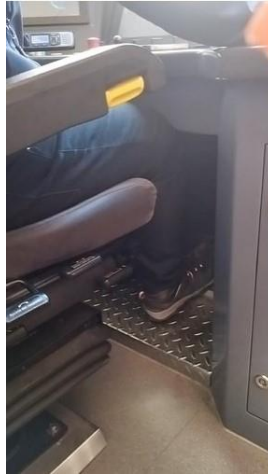
Figura N°26. Operación pedal hombre muerto
