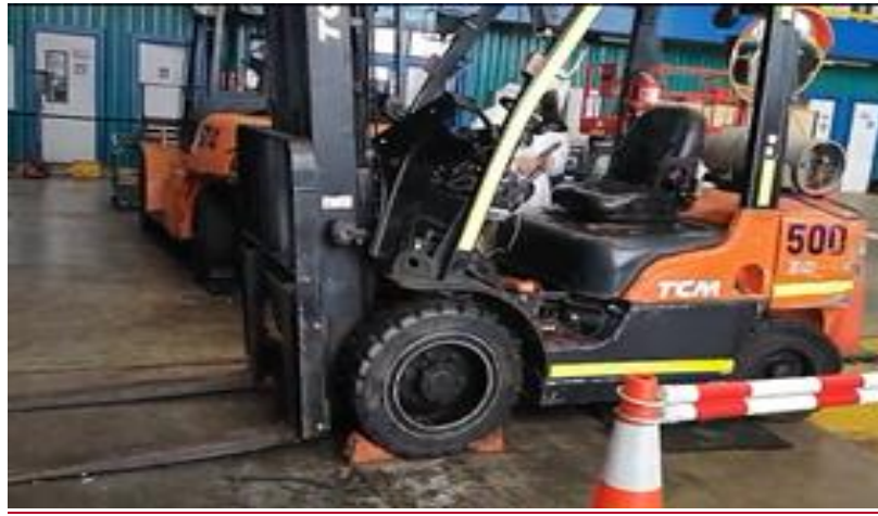
Fotografía 3: Trabajador simulando como saca un neumático, retirando las tuercas que lo mantienen sujeto con una llave de impacto.
