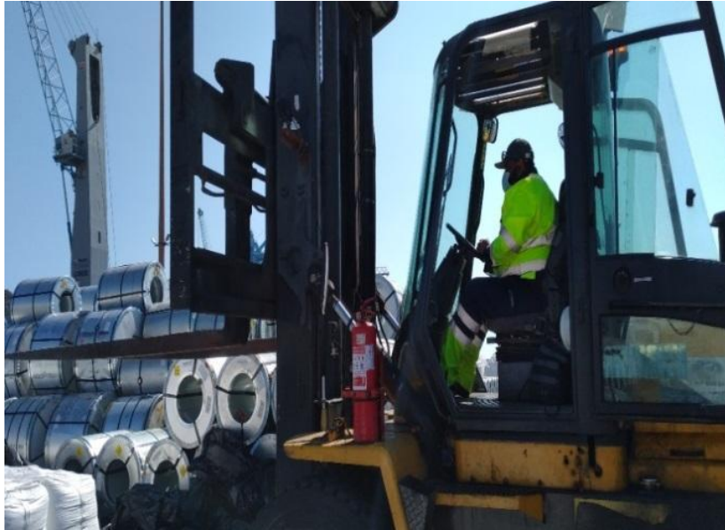
Fotografía 2: Se aprecia la visión anterior dificultosa que tiene el operador de la grúa horquilla.
