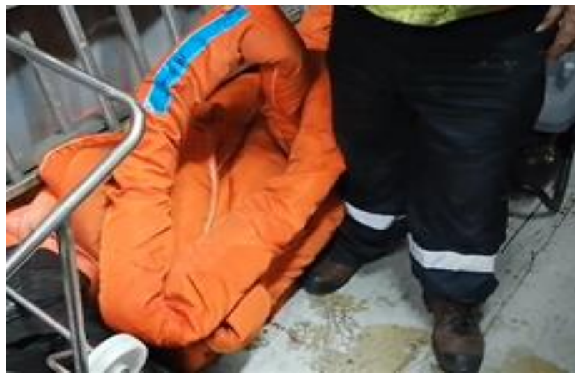
Fotografía 6: Faja tubular de alta densidad, es capaz de levantar 40.000 kilos.
