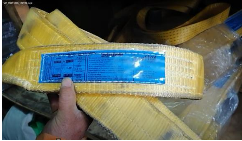
Fotografía 5: Faja de poliéster que puede llegar a soportar 10 toneladas. Peso aproximado de 3 kilos.
