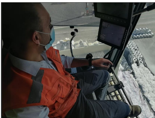
Fotografía 5: Cabina de grúa Gotwald con pantallas a la izquierda.
