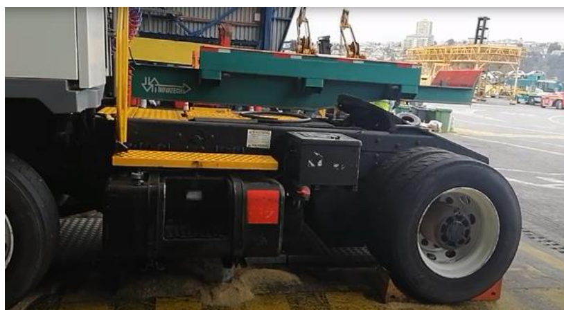
Fotografía 4: Tractocamión en reparaciones. Destaca el tamaño del neumático. Como se mencionó anteriormente en algunas empresas portuarias la reparación de neumáticos está externalizada, e incluso los trabajadores externos retiran y ponen los neumáticos, mientras en otras estas labores las hacen trabajadores portuarios.
